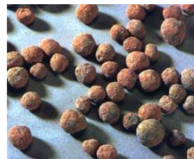
膨張材との併用により温度ひび割れ 抵抗性を向上させる軽量骨材
