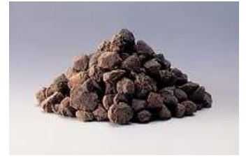
膨張材との併用により温度ひび割れ 抵抗性を向上させる軽量骨材
